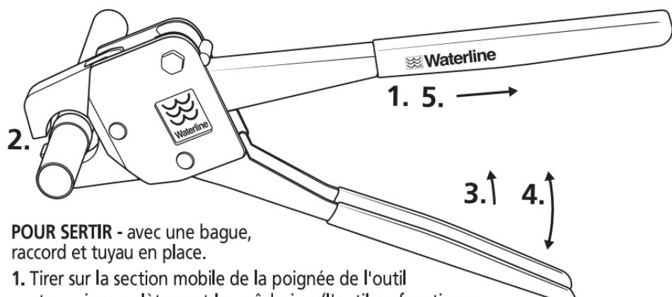
**POUR SERTIR** - avec une bague, raccord et tuyau en place.
